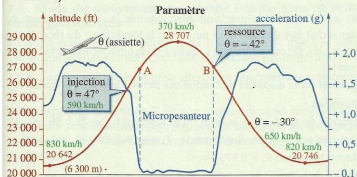
Lors de la première phase de vol, l'avion évolue à l'horizontale. Le pilote prépare sa parabole en augmentant progressivement sa vitesse jusqu'à environ 830 km/h, vitesse maximale autorisée pour ce type d'appareil. Puis il cabre progressivement l'appareil pour atteindre un angle de  $47^\circ$ . Il s'instaure, pendant cette manœuvre, une forte pesanteur appelée *hyperpesanteur* : les passagers pèsent 1,8 fois leur poids sur Terre.
