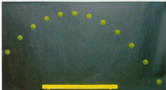
On a réalisé, ci-dessus, la chronophotographie du mouvement d'une balle dans le champ de pesanteur. L'intervalle de temps entre deux positions consécutives de la balle est de 67 ms. On choisit comme origine des temps  $t_0 = 0$ , la date à laquelle la balle se trouve sur la position la plus à gauche. La règle mesure 1,0 m.
