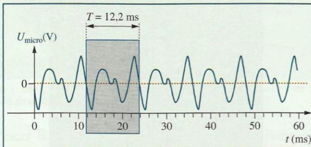
Doc. 2 Le son émis par la plus grosse corde d'une guitare n'est pas pur, car le signal obtenu n'est pas sinusoïdal. Il est périodique de période  $T = 12,2$  ms et de fréquence
