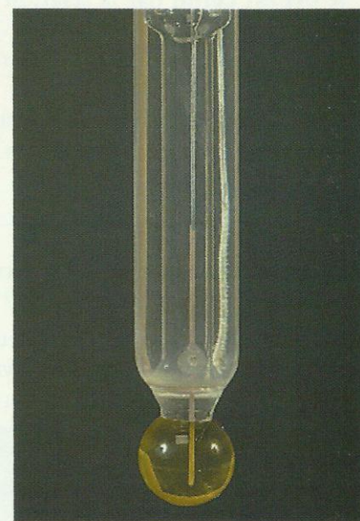
Doc. 6 Sonde de mesure du pH.
