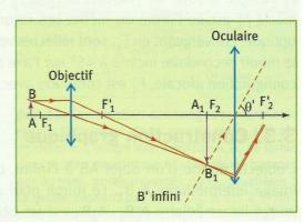
**Doc. 17.** Construction des images et marche de rayons lumineux dans un microscope modélisé. L'image définitive de A par le microscope est à l'infini dans la direction de l'axe optique.
