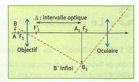
**Doc. 16.** Microscope modélisé par deux lentilles minces. La distance entre F<sub>1</sub>, foyer image de l'objectif, et F<sub>2</sub>, foyer objet de l'oculaire, définit l'intervalle optique du microscope. L'image définitive de A est à l'infini, dans la direction de l'axe optique du microscope.
