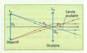
**Doc. 18.** Construction du cercle oculaire d'un microscope modélisé.
