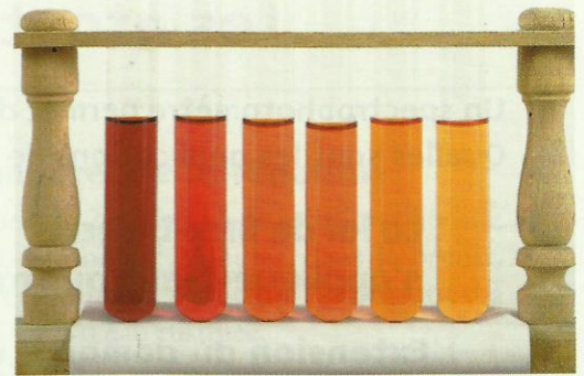
Doc. 16 Échelle de teinte. Lorsqu'une seule espèce est colorée, on peut utiliser la colorimétrie avec échelle de teinte. On compare la teinte que prend le tube contenant le système étudié à celle des tubes témoins de l'échelle de teinte : on obtient un encadrement de la concentration en espèce colorée.
